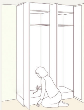
ジャッキアップハンドルをシャフトに差し込みロックを解除
